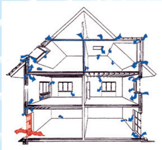
Das Prinzip der BlowerDoor Messung: Ein Ventilator saugt Luft aus dem Gebäude. Außenluft strömt durch undichte Stellen ins Gebäudeinnere.
